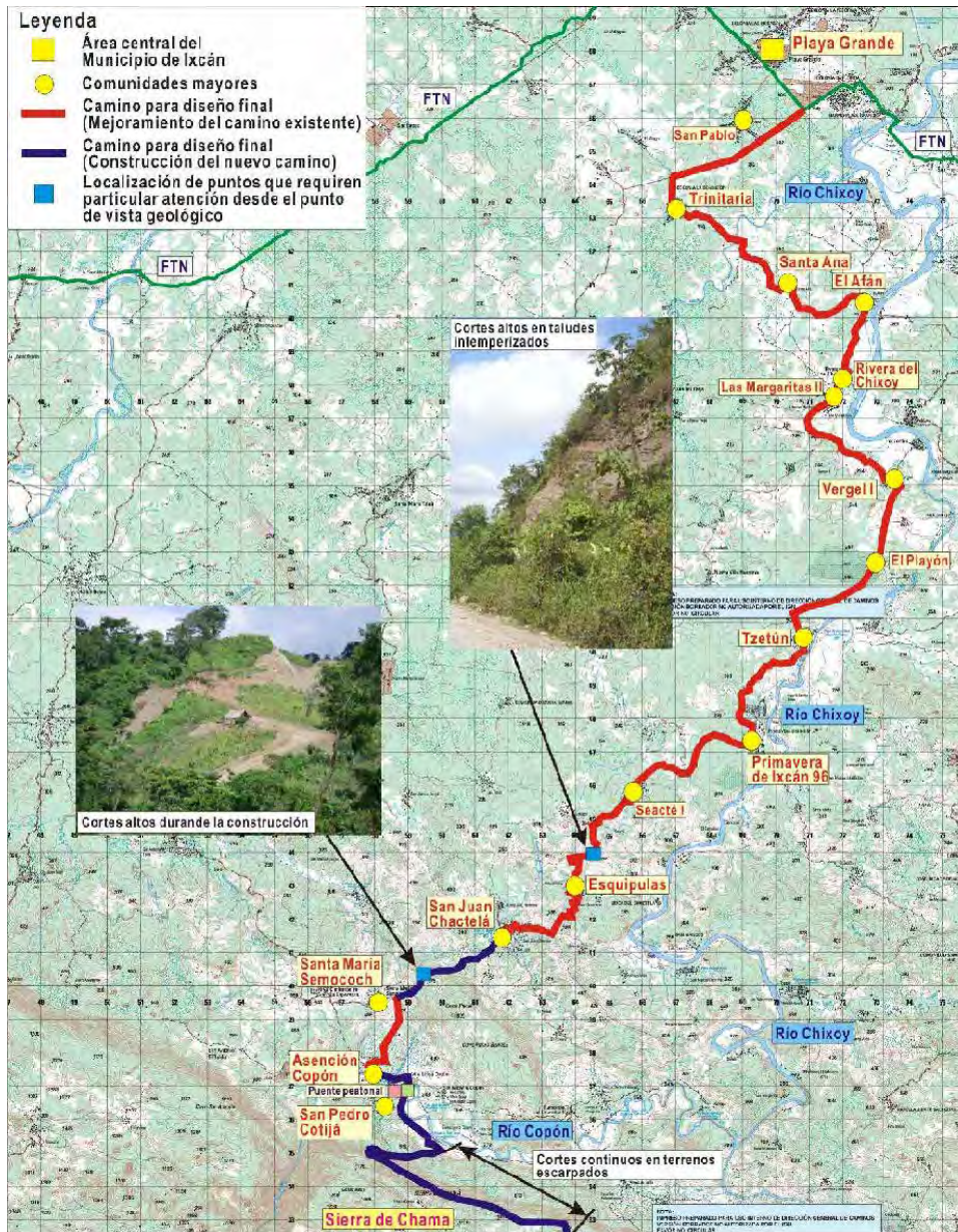
Figura 3-14 Localización de puntos con potenciales cortes altos y que requerirán especial atención desde el punto de vista geológico
