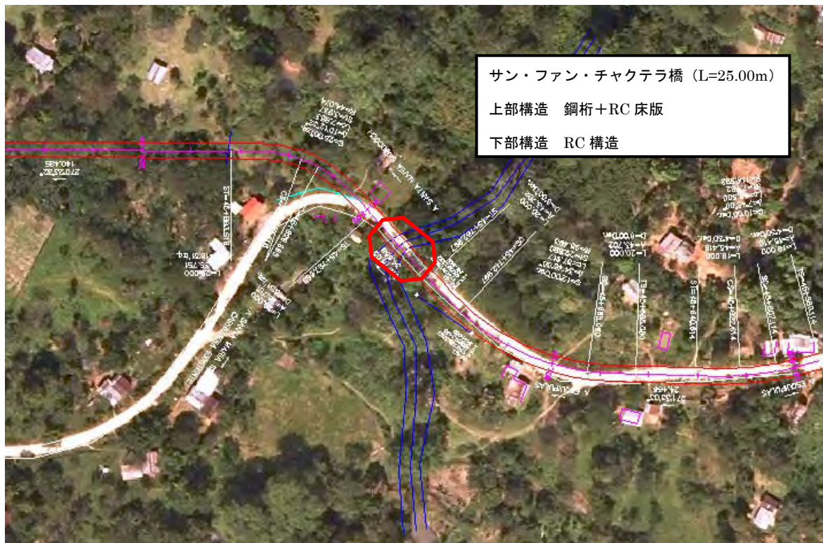
図8-10 サン・ファン・チャクテラ橋の橋梁架け替え位置
