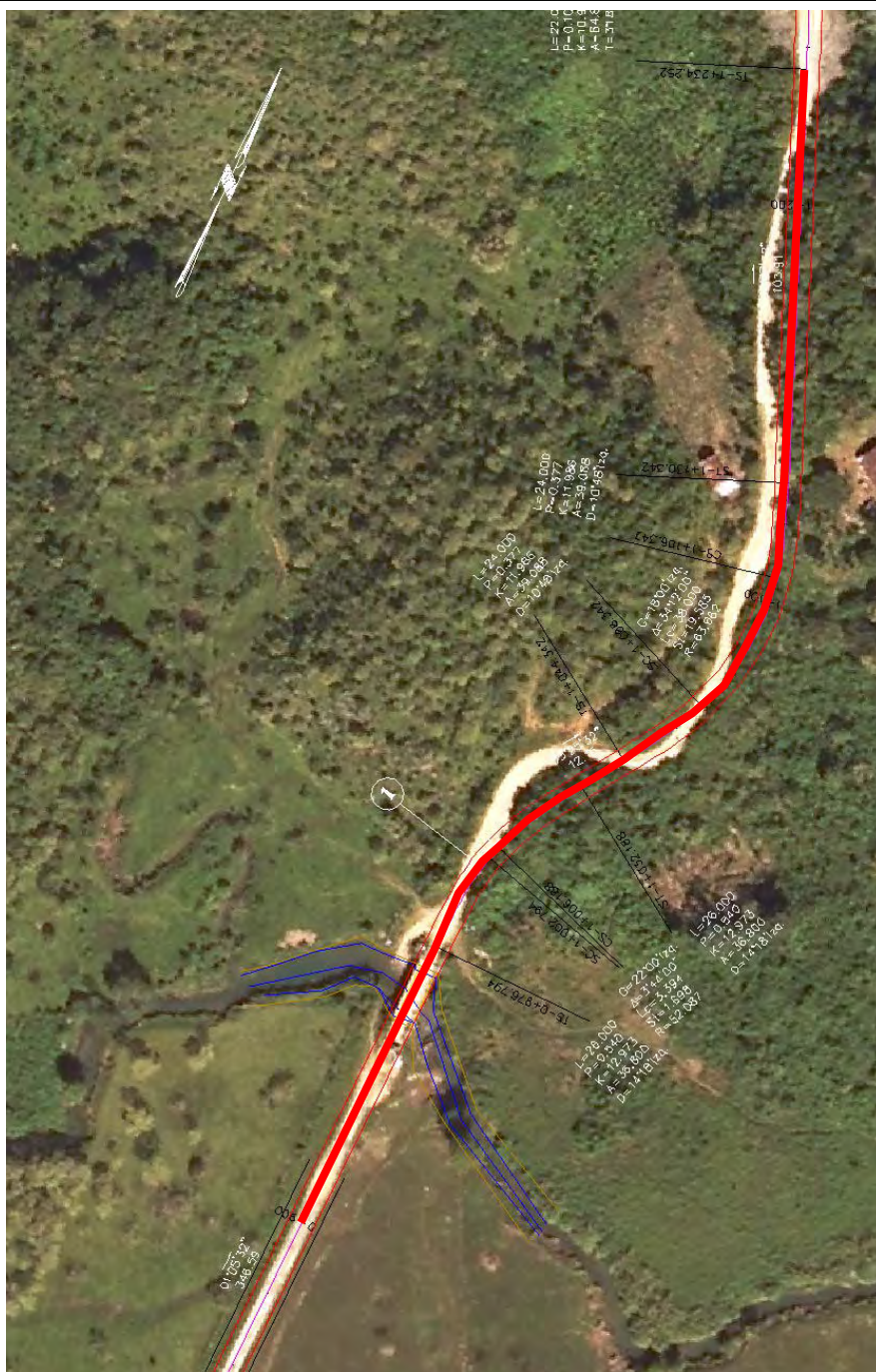
図7-22 チカマン～エル・パライソ間の線形変更箇所（ランセティージョ橋）
