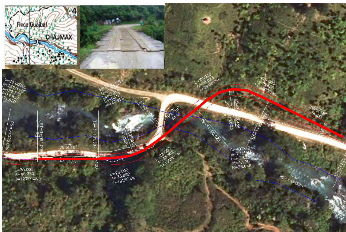
図7-28 ランキン～ラ・ソレダッド間の線形変更箇所（ランキン橋）
