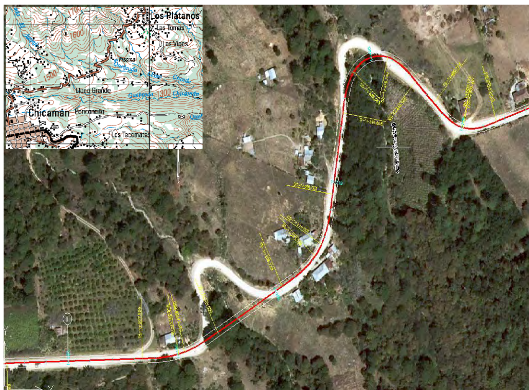
図7-14 チカマン～エル・パライソ間の線形変更箇所（ジャーノ・グランデ）
