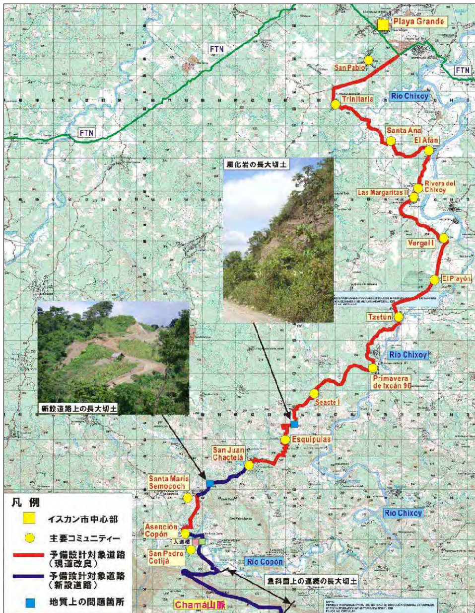
図3-14 イスカン～コポン川間の地質上の問題箇所及び長大切土計画区間
