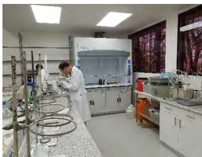
Campana de extracción de gases
