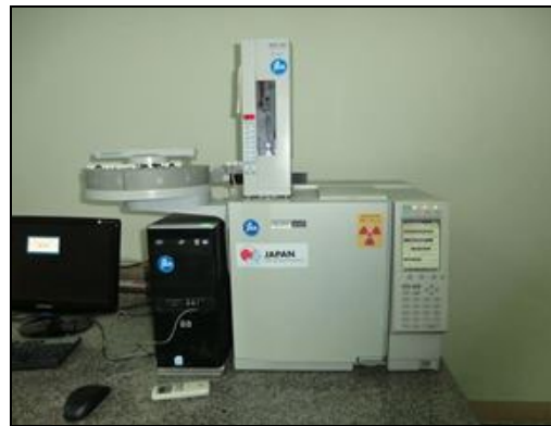
試料中の各成分の含有量を測定する ガスクロマトグラフと関連部品 (「水環境技術」の供与機材)
