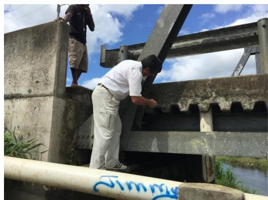
反発強度試験／床板
