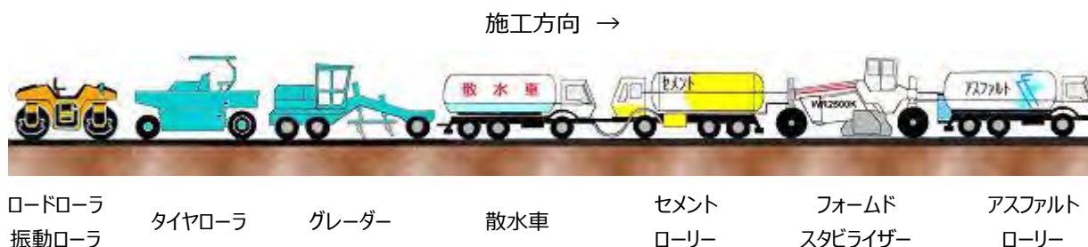
図 10.2.1 路上路盤再生工法のイメージ図
