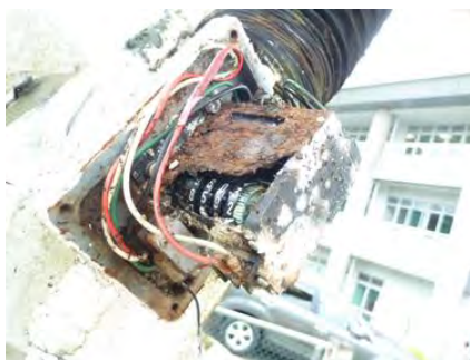
写真-7 EL Resolver (仰角回転角検出器) /Limit SW (位置検出器) モジュール部の破損
