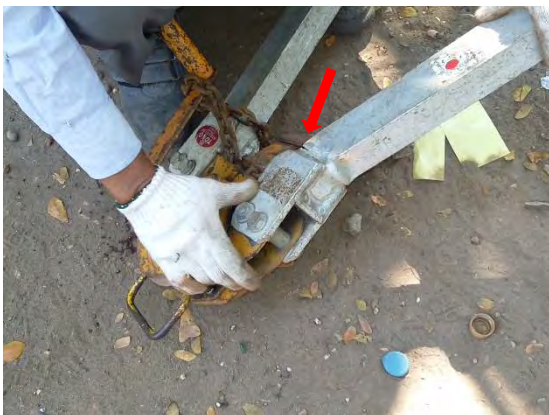
き裂が入ったレール吊り上げ器
