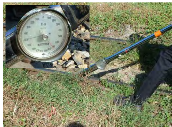
継目ボルトのトルク
