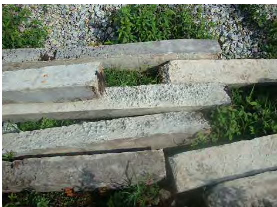
豆板だらけの 50N 用 PC マクラギ底面
