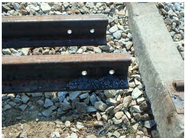
穿孔した50Nレール
