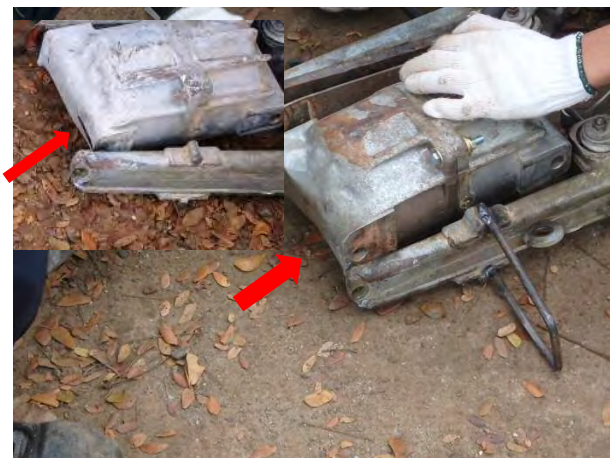
本体部の亀裂修理
