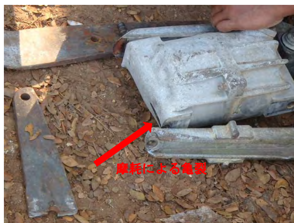
破損したブレードと本体部の亀裂
