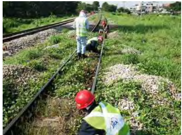
正矢量測定(上り線曲線部)
