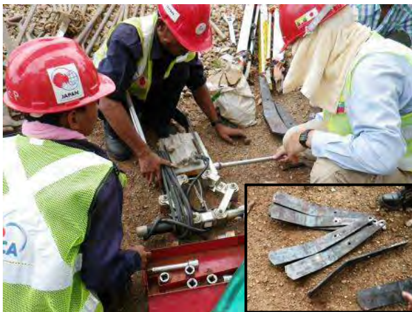
タイタンハンマーのブレードの交換
