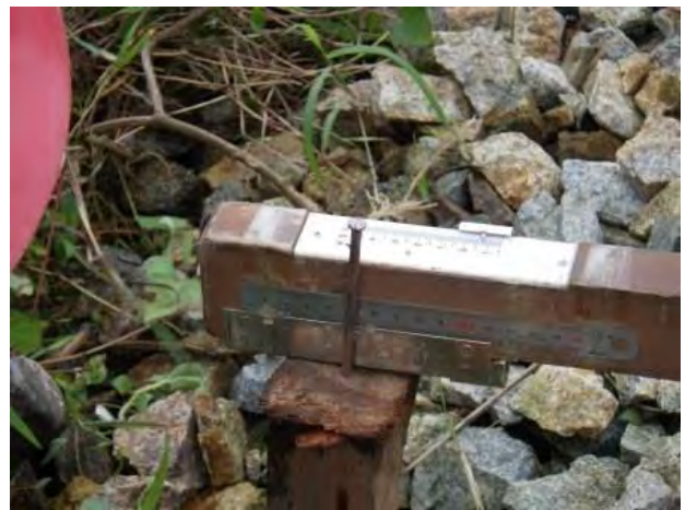
標準ゲージで作った縦距測定器
