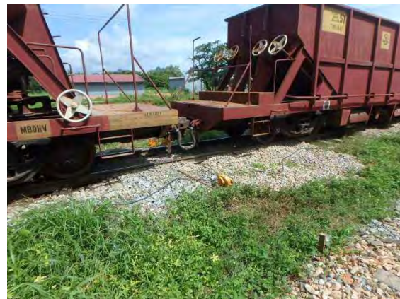
通過したホキ車（ホースが貫通している）
