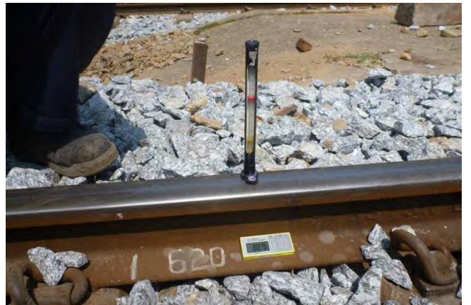
レール温度計 【上:ミャンマー(中国製) 下:日本】
