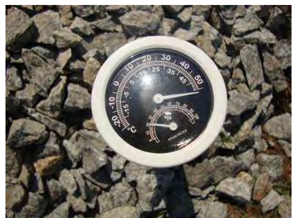
仮杭上端における温度約57°C
