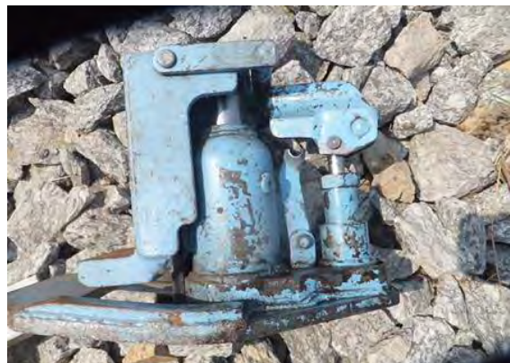
損傷した日本製豆ジャッキ
