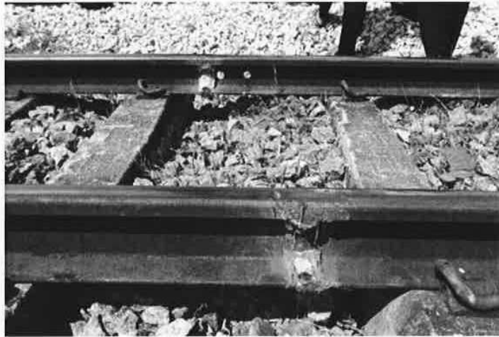
Welding အခြေအနေ( welding အနိငယ်မသေသပ်မှု အခြေအနေ)
