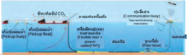
ระบบการขนส่งและการกักเก็บด้วยขั้วทเทิลขีป (การอัดฉีดด้วยแรงดันจากเรือไปยังใต้ก้นทะเล)
