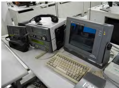
トレーニング・センター (GMDSS シミュレーター)
