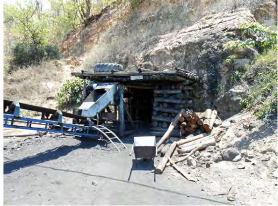
2 : コンベイヤー用坑口
