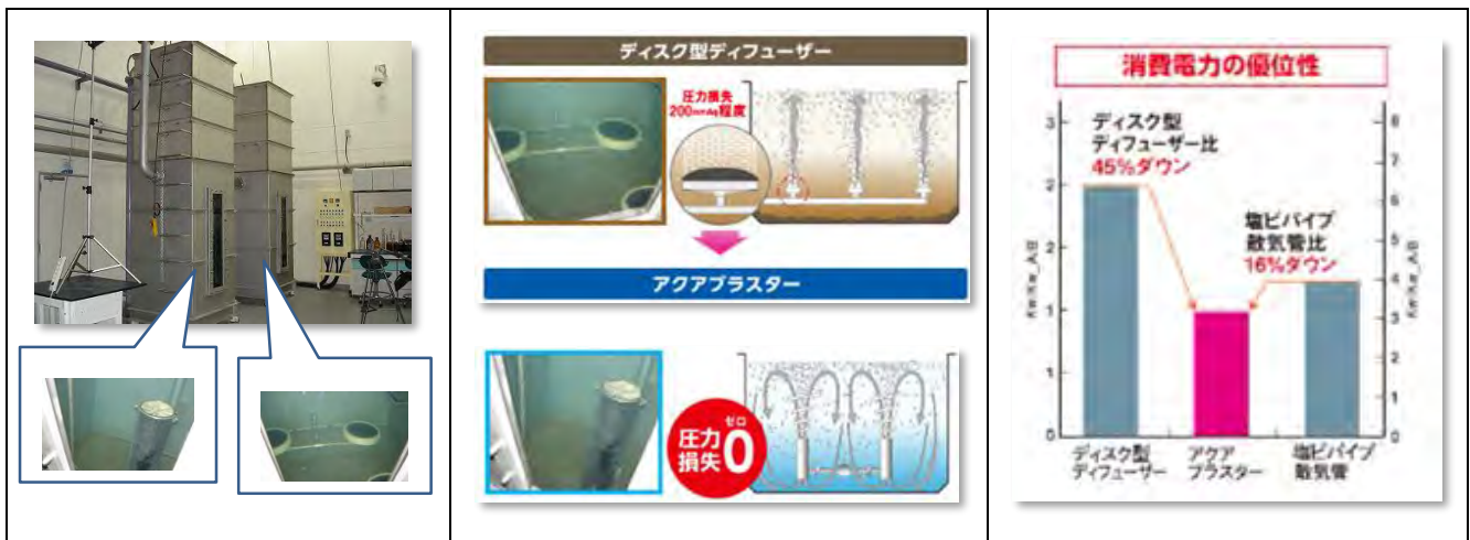
図 2.9 消費電力（ディスク型ディフューザー比）
