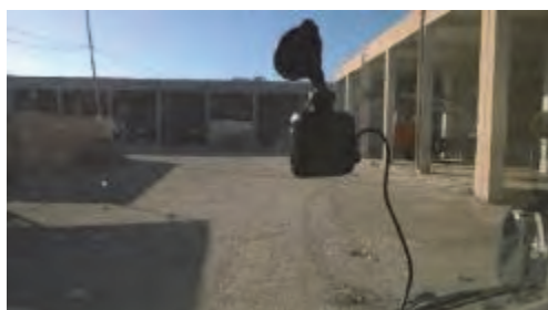
Photo 5-9: Enregistreur de conduite doté de fonctions GPS introduites
