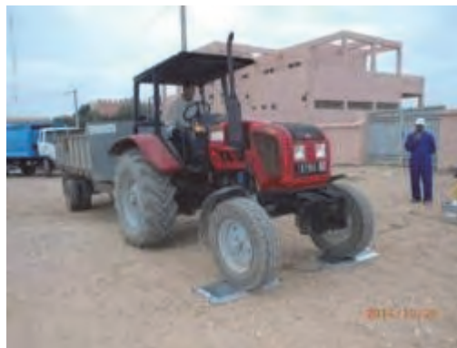
Photo 4-2 : Tracteur d'Aglou équipé d'une remorque de collecte de déchets (Charge utile : 3,6m 3 )
