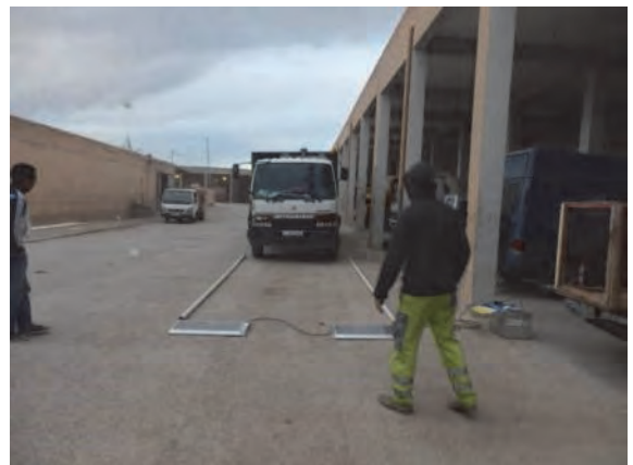
Mesure de poids d'un véhicule par un pont-bascule portable
