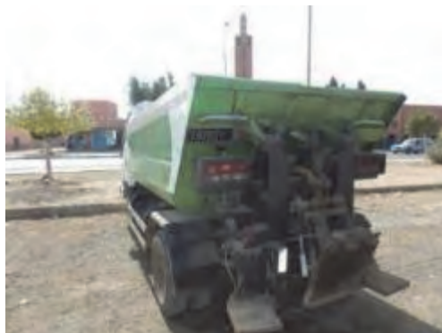
Photo 4-3: Benne Satellite équipé d'un bras de levage pour soulever conteneur: (Charge utile: 3,3t selon l'enquête par entrevue)
