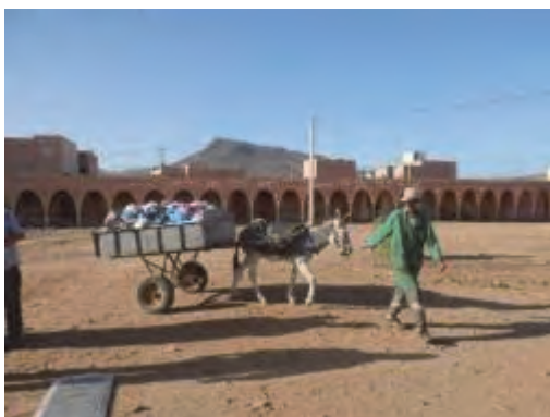
Photo 4-5 : Collecte à l'aide d'un âne et d'une charrette (Charge utile : 0,8m 3 )
