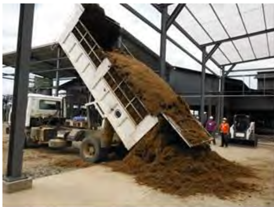
堆肥原料(破碎 EFB) 搬入
