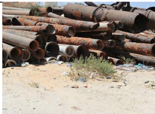
老朽化した配水管(給水塔付近の資材置場にて)
