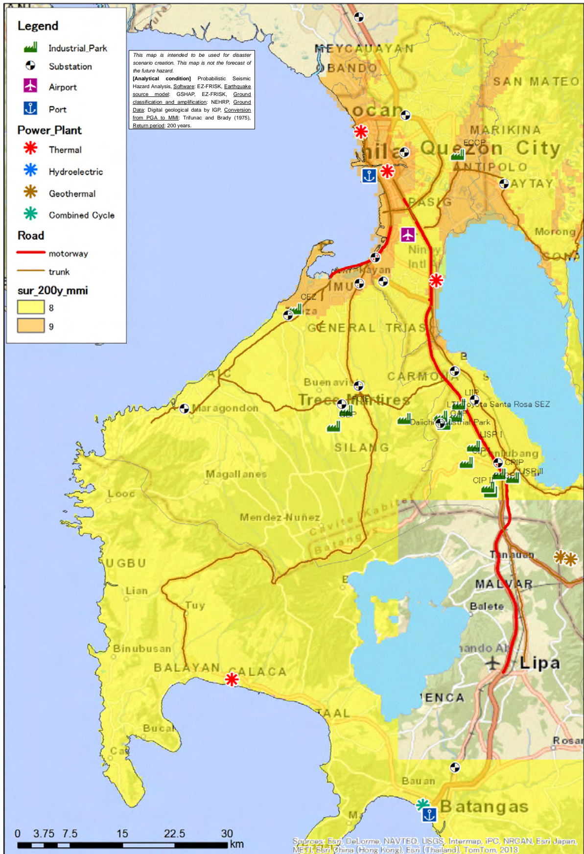
図 1.2.2 200年に1回の発生確率を想定した地震の震度と重要施設の分布
