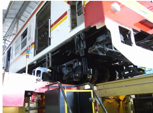
写真2. 車輪研削機にセットされたメンテナンス車両
