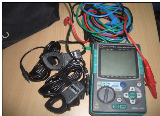
(供与されたエネルギー監査用測定機器)
