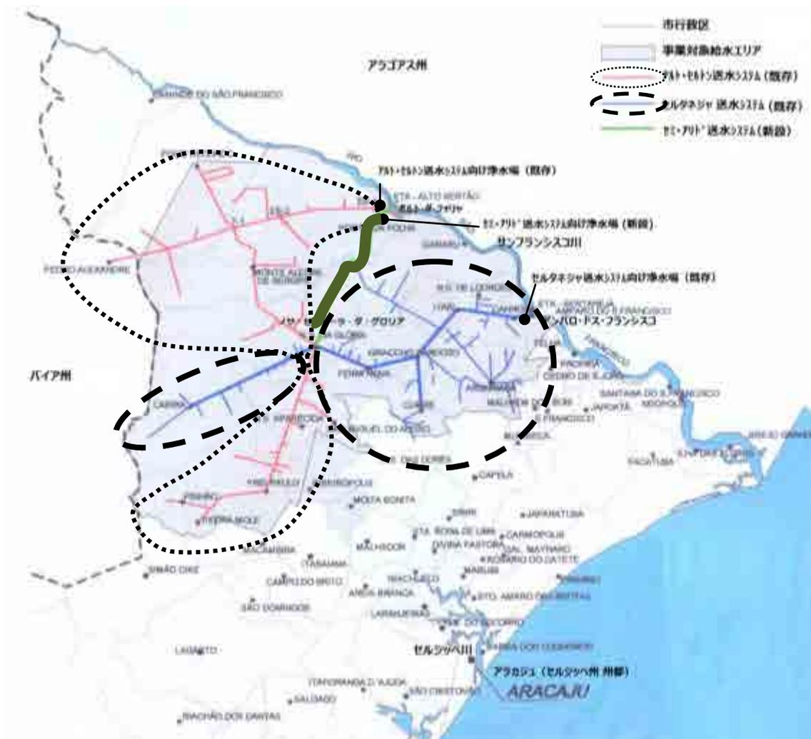
出所：アト／メディオ・セルトン地域、ならびにサンフランシスコ流域の水資源管理計画対象地域は、8,837 平方キロメートルにも及び、25 の市を対象としている。緑色部分がセミ・アリド送水管、茶色部分がアト・セルトン送水管、青色部分がセルタネジャ送水管である。これらの3つの送水管が交差している中央の市がノサ・セニョーラ・ダ・グロリア市である。
