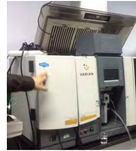
原子吸光分光光度計。石炭坑の労働衛生評価における重金属の試験中。（商丘師範学院）
