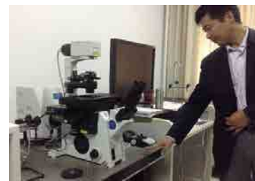
生命科学学院の共焦点レーザー顕微鏡。状態は良好。 (安徽大学)
