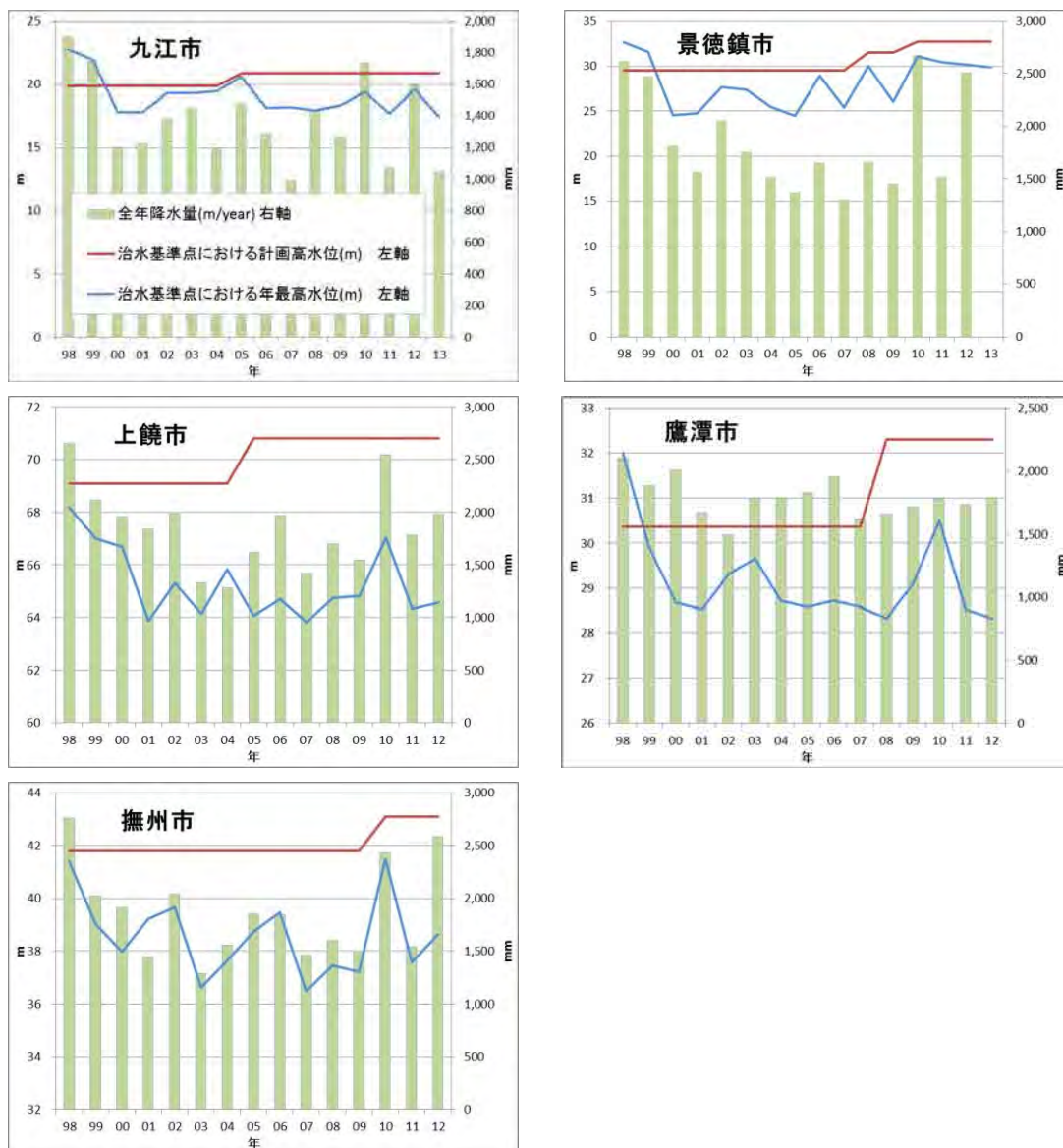
図 3 治水基準点における計画高水位（実績値）と年最高水位の比較
