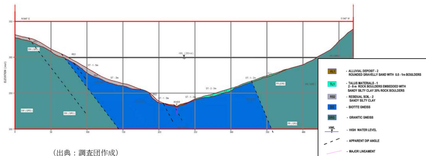
Figure 10.4.2-5 Maha 2 下池ダム地質断面 (1:10,000)
