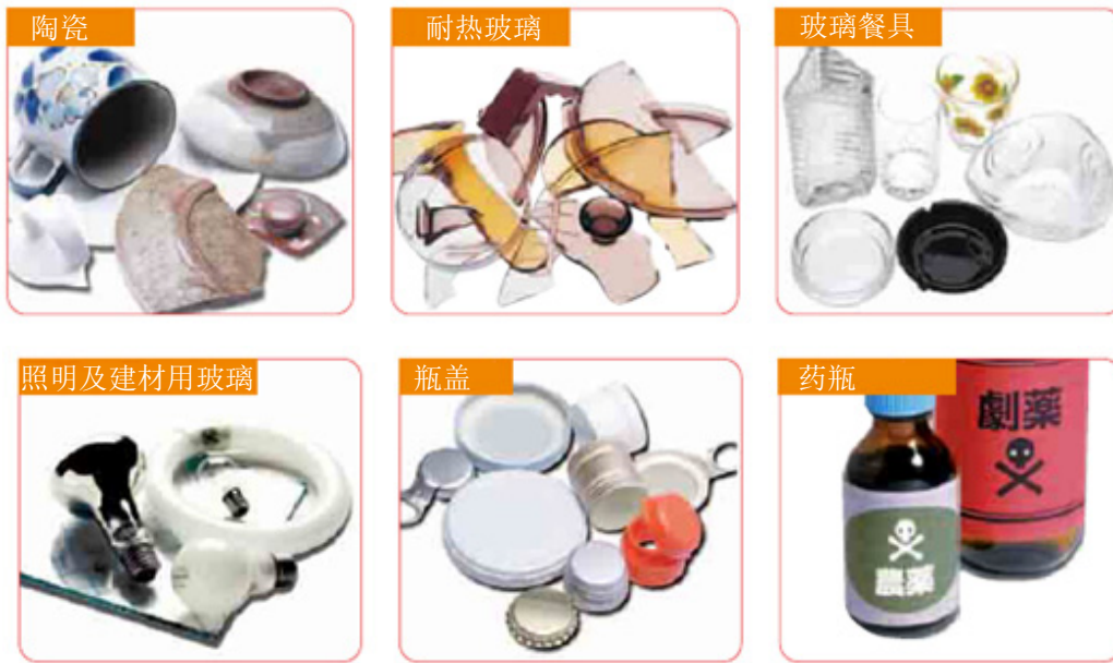
图 5-11 玻璃瓶回收时不宜混入的物品
