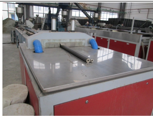
从挤压机中出来的纸塑铝复合材料 1
