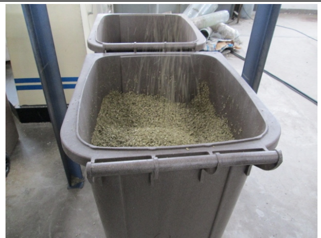
粉碎后的报废纸制复合容器（纸塑铝复合材料）
