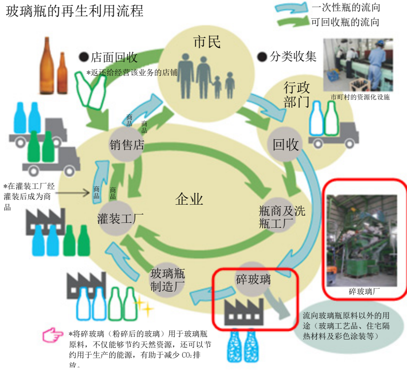
图 5-12 日本的玻璃瓶再生利用流程
