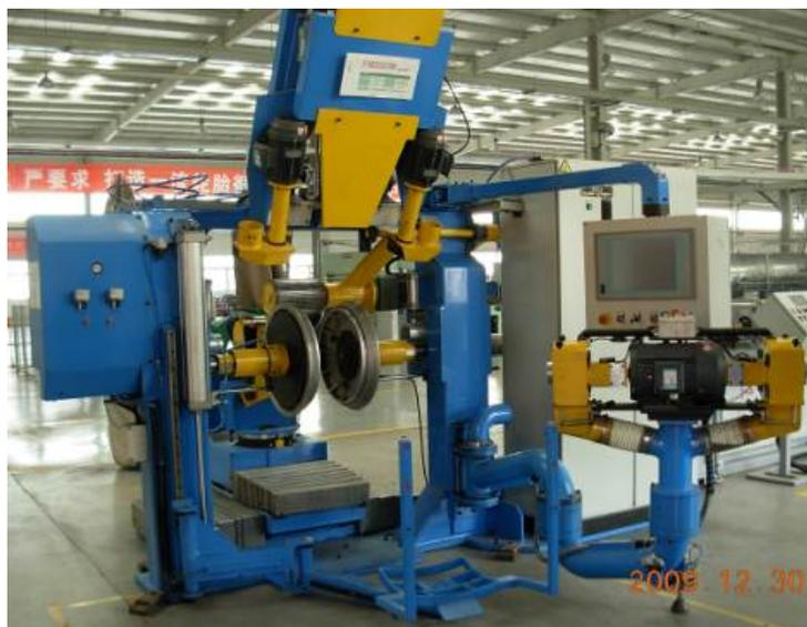
全自動タイヤ研磨装置はさまざまな規格のタイヤのカーブに対応することができる。メーカー別に設定し、コンピューターに記憶させ、作業時に呼び出すため操作しやすく、リ・モールド方式、プレキュア方式のいずれの研磨成形にも適している。タイヤの偏摩耗を自動的に矯正して研磨成形する。研磨プログラムは両側ショルダー部の研磨半径を制御可能である。レーザーが自動でタイヤ外周の長さを計測する。研磨によるベルト層の損傷を避けるため、コード層検知器でトレッドベースゴムの厚さを測る。高精度のデジタル化研削制御により研磨精
