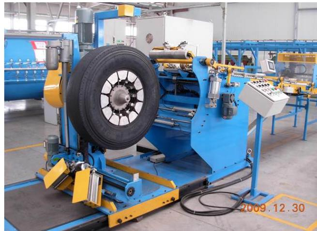
FTT-Z225 型トレッド自動貼り付け装置は自動でタイヤ外周長を計測し、トレッドを一定の長さに裁断する機能を持ち、トレッドの裁断効率を向上させている。トレッドの自動テンション機能により、トレッドがカーカスに対して一定のプリテンションがあり、トレッドを強固に貼り合わせられるとともに、トレッドの節約にもつながる。トレッドが自動で中心に合わせられるため、均等な貼り合わせが可能で、効率が高い。自動ローラーにより、タイヤの規格を変える際に機械を調整する必要がない。制御には PLC 制御システムを採用し、さまざまな機能モジュールによる機能拡張と増設に対応が可能であり、製品機能のグレードアップや更新を速やかに行うことができる。リモートコントロールポートおよびシステムネットワーク管理ポートがあり、今後の現代化管理に適したものとなっている。
