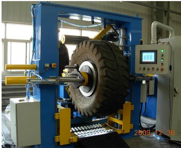
コンピュータのタッチパネルにより、設備操作やパラメーターの変更が簡単にできる。さまざまな規格のタイヤの研磨曲線に対し、メーカーごとに設定し、コンピュータ内部に保存して使用時に呼び出すことができ、操作しやすく、リ・モールド方式、プレキュア方式のいずれの研磨成形にも適している。タイヤの偏摩耗自動的に矯正して研磨成形する。研磨プロセスは両側ショルダー部の研磨半径を制御可能である。高精度のデジタル化研削制御により研磨精度を保証し、研磨品質を高めた。研磨ヘッドの交換時の事故を避けるため、ヘッド部起動保護装置を採用し、オペレーターの安全を確保している。メインの研磨ヘッドのブレード冷却システムには、タイヤ昇降装置が付属し、作業者の労働強度を下げています。タイヤのアライメントにはダブルピストン構造を採用し、ピストンは空気圧により自動制御される。PLCによる制御で、各種機能モジュールによる機能拡張と増設に対応が可能で、また工場情報化用の通信ポートにより製品機能のグレードアップや更新を速やかに行うことができる。タイヤの研磨品質は良好で効率よく研磨できる。
