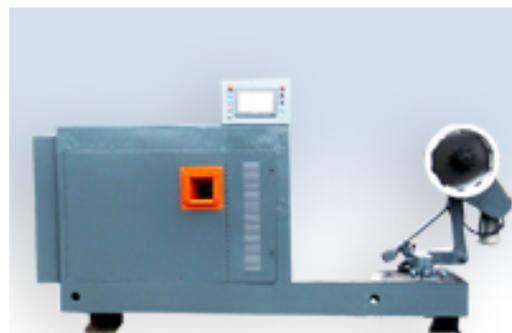
る。PLCによる制御で、各種機能モジュールによる機能拡張と増設に対応が可能で、また工場情報化用の通信ポートにより製品機能のグレードアップや更新を速やかに行うことができる。トレッドゴムの巻き付け品質は良好で、重量が平均しており、原料ゴスを節約し、効率が高い。
