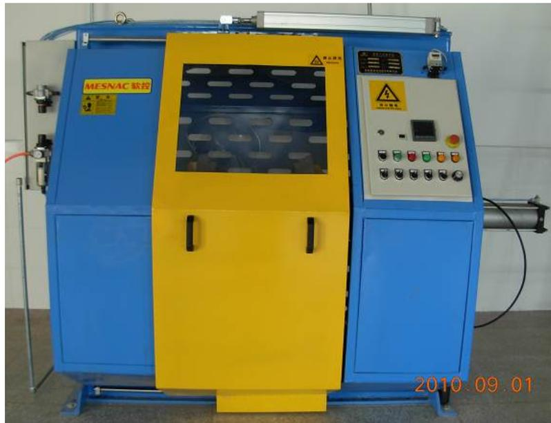
圧の3段階の設定があり、連続無段階の設定も可能である。空気圧の数値は電気比例弁により正確に制御され、タイヤのバーストによる事故を減らしている。リモート制御およびシステムネットワーク管理用のポートを設けている。
