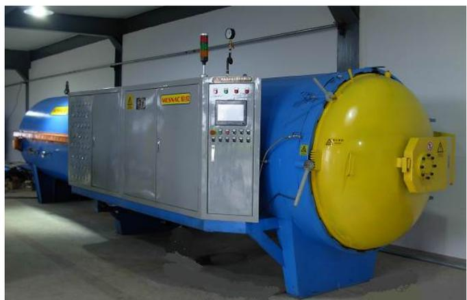
できる。圧力自動調節機能 (DPC) が加硫タイヤの品質を保証する。さまざまな機能モジュールによる機能拡張と増設に対応が可能であり、また工場情報化用の通信ポートを用意しており、製品機能のグレードアップや更新、診断、修正をオンラインで速やかに行うことができる。真空装置には、ダブルエンベロープ方式による加硫とリム加硫システムを採用可能である。またエンベロープ法によるリークテストに単独で用いることもできる。
