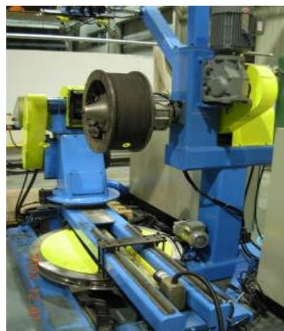
ムを採用し、さまざまな機能モジュールによる機能拡張と増設に対応が可能である。また工場情報化用の通信ポートを設けてあり、製品機能のグレードアップや更新を速やかに行うことができる。オプションでレーザーによるタイヤ外周長計測およびコード層検知器によるトレッドベースゴムの厚さの検出が可能である。
