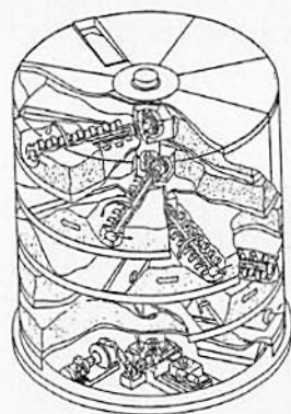
図10.3.3-4 立型多段発酵槽(パドル式)
