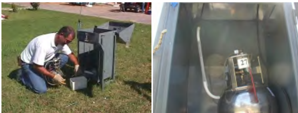
Figura 2.1.1.14 – Tomado de muestras en campo (izquierda) y canister (derecha).
