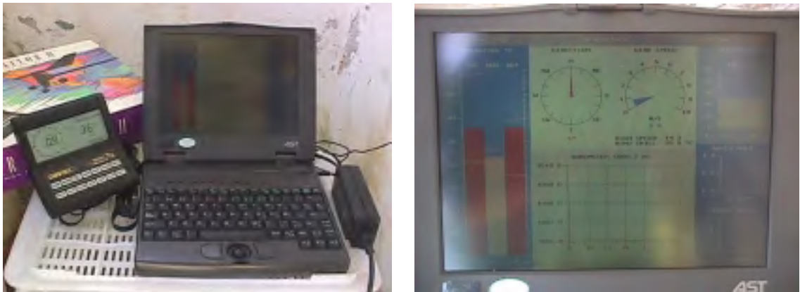
Figura 2.1.7.2 – Izquierda: central Davis y computadora portátil de almacenamiento de registro continuo. Derecha: vista de la pantalla con el software de presentación de valores instantáneos.
