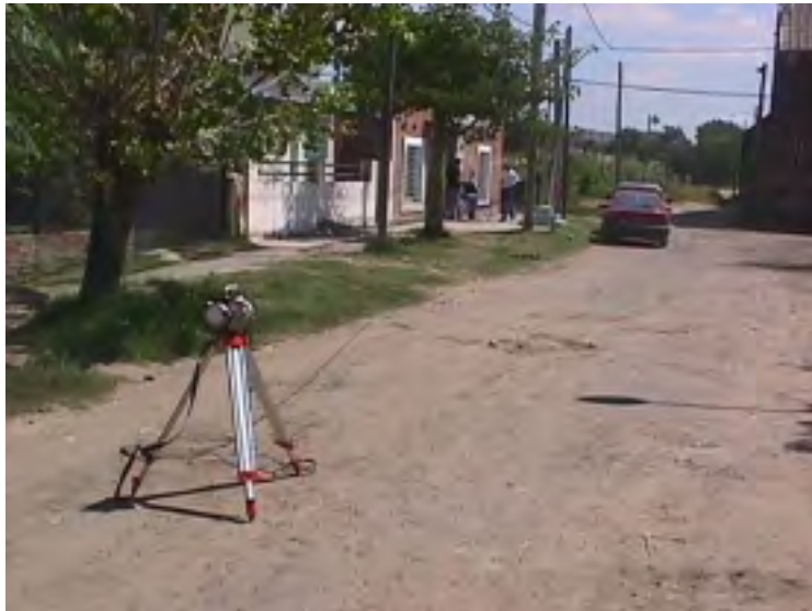
Figura 2.1.3.5 – Toma de muestra de TSP con bomba portátil en Villa Inflamable, en la calle Gongora esquina Canalejas.
