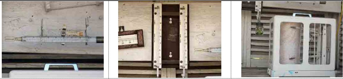
写真 5 百葉箱内の各種測器・データログ
