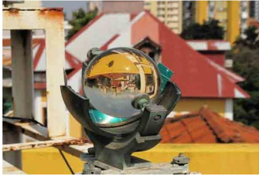
写真 6 カンベル型日照計 途上国において広く利用されている
