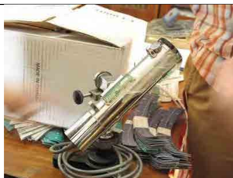
写真 18 スイス・ダボスで検定された直達日射計 (室内で管理)
