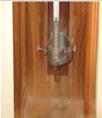
写真 8 フォルタン型水銀気圧計（官執部屋に設置） （左上）全体：右壁に気圧補正表がある。 （右上）気圧計上部の読み取り部 （左下）気圧計下部 （右下）気圧計補正表：気圧補正値を記入した校正表
