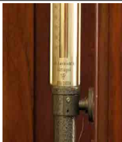
写真 8 フォルタン型水銀気圧計（官執部屋に設置） （左上）全体：右壁に気圧補正表がある。 （右上）気圧計上部の読み取り部 （左下）気圧計下部 （右下）気圧計補正表：気圧補正値を記入した校正表
