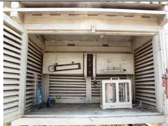
写真 4 百葉箱（内部の各種測器）
