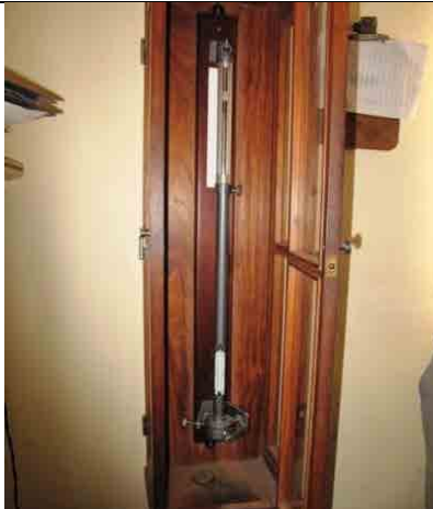
写真 8 フォルタン型水銀気圧計（官執部屋に設置） （左上）全体：右壁に気圧補正表がある。 （右上）気圧計上部の読み取り部 （左下）気圧計下部 （右下）気圧計補正表：気圧補正値を記入した校正表
