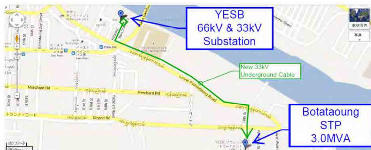
図 3.13 下水処理場(STP)と 33kV 直埋設ケーブルルート
