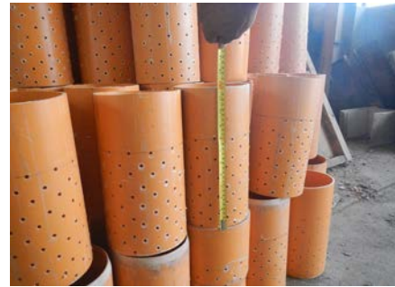
図 13 : パーチ管・写真 (水田の水量調整が可能)
