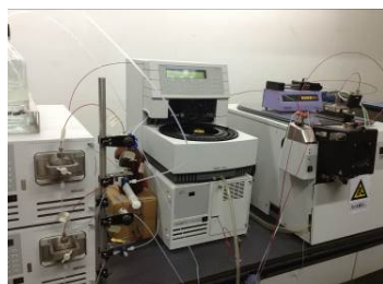
国家重点実験室の主要設備となった液体クロマトグラフ質量分析計（四川農業大学動物栄養研究所）
