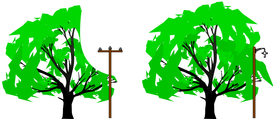
図 3 配電線と樹木の関係 (左：裸線の場合、右：絶縁線の場合) (ANDE 提供)
