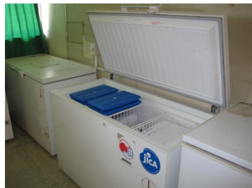
写真 1 本プロジェクトで供与したアイスライン式冷蔵庫（トンガ）
