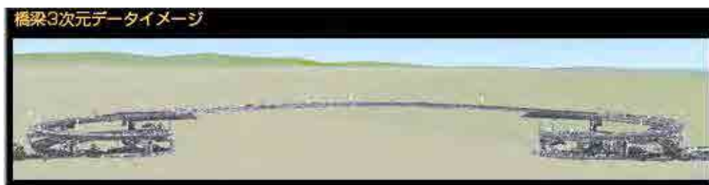
図 2.2-20 : MMS で3次元計測された橋梁の例 (パスコ HP)
