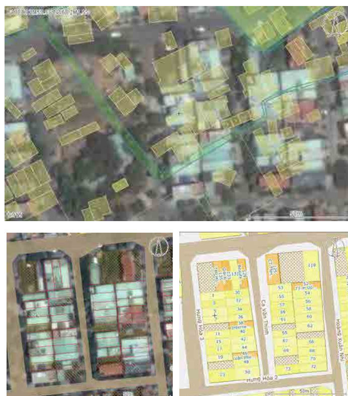
図 2.2-11: ベトナム国での地図・GISの実証実験イメージ(日立ソリューションズ、ゼンリン) (上: 衛星画像の上に基盤地図を重ね、左下: 道路と家枠をトレース、右下: 完成した地図)
