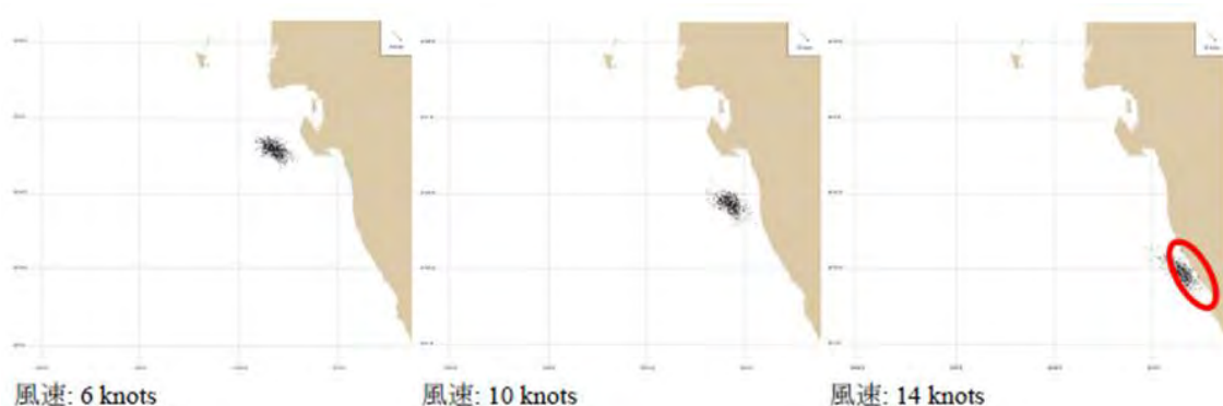
شکل ۴.۸-۲ پایانه شرقی بارگیری در جزیره خارک، مسیر نشت نفت پس از ۵ روز (فوریه تا اکتبر، باد در جهت شمال به غرب)
