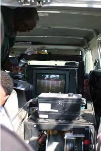
井戸孔内カメラ機材の実習の様子(モニター及びウインチは車両搭載のまま使用する)
