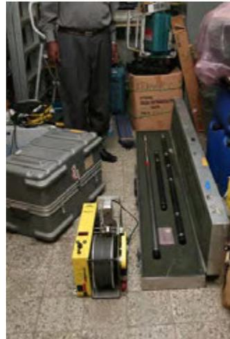
検層機及びプローブ(実際の運転には小型発電機も必要)
