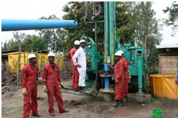
写真-5 既存掘削機を用いた井戸掘削実習
