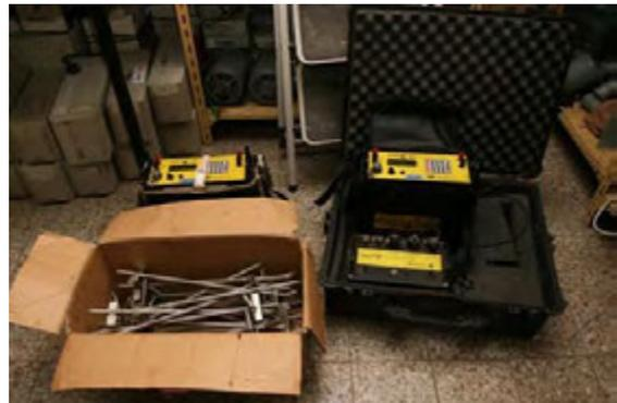
電気探査機材(調査には探査機1台につき、ドラム巻きケーブルが最低4個必要)
