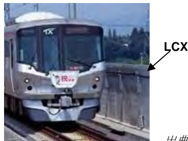
図 7.2-6 LCX を用いたデジタル列車無線
