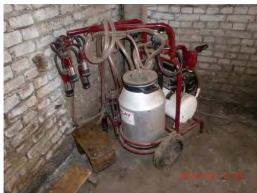
Фото 2-11 Дорогой доильный аппарат, используется для доения без промывки.
