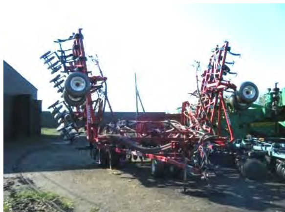
Фото 7-1 Конструкция из сеялки «Глен», культиватора и катка
