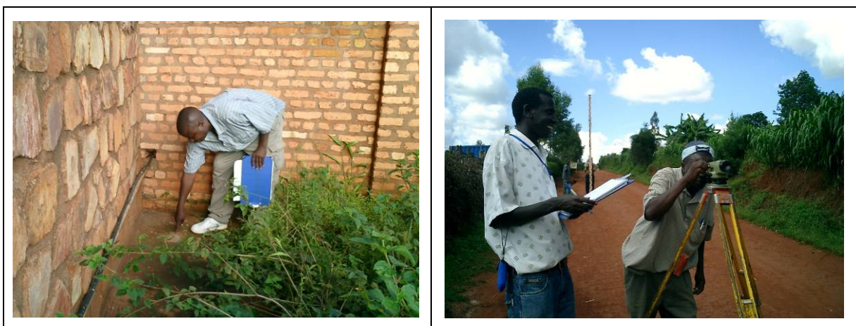
Figure 15 Scènes de nivellement (à gauche : point de nivellement existant, à droite, nivellement)
