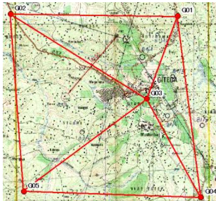
Figure 10 Plan de disposition des points de calage et conditions d'observation (carte d'ajustement du réseau) (Gitega)
