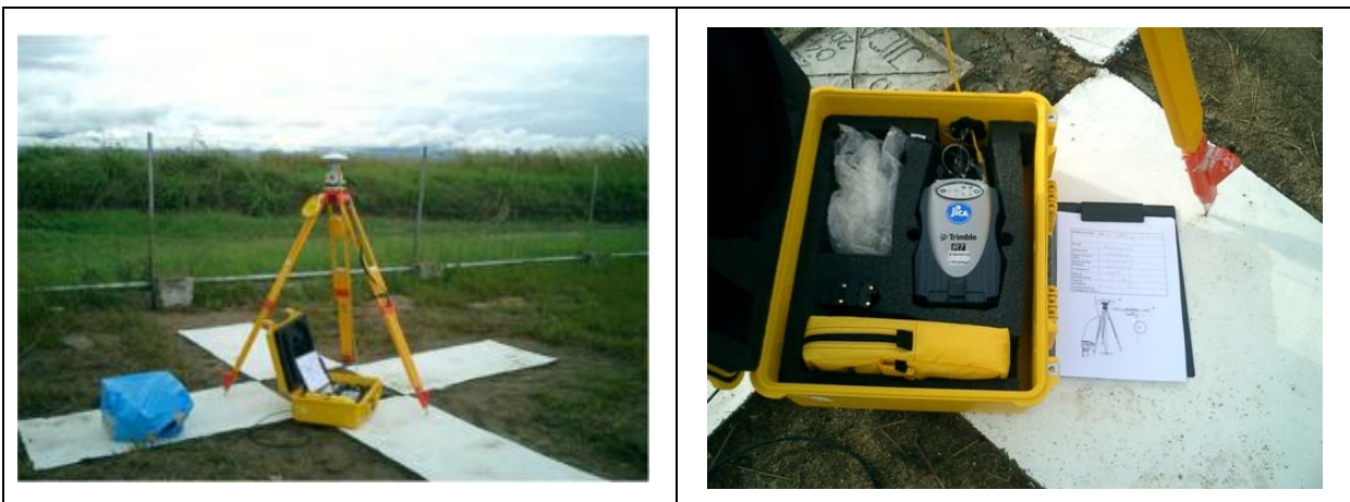
Figure 11 Scènes des levés des points de calage (à gauche : signes aériens et observation, à droite : équipement d'observation)
