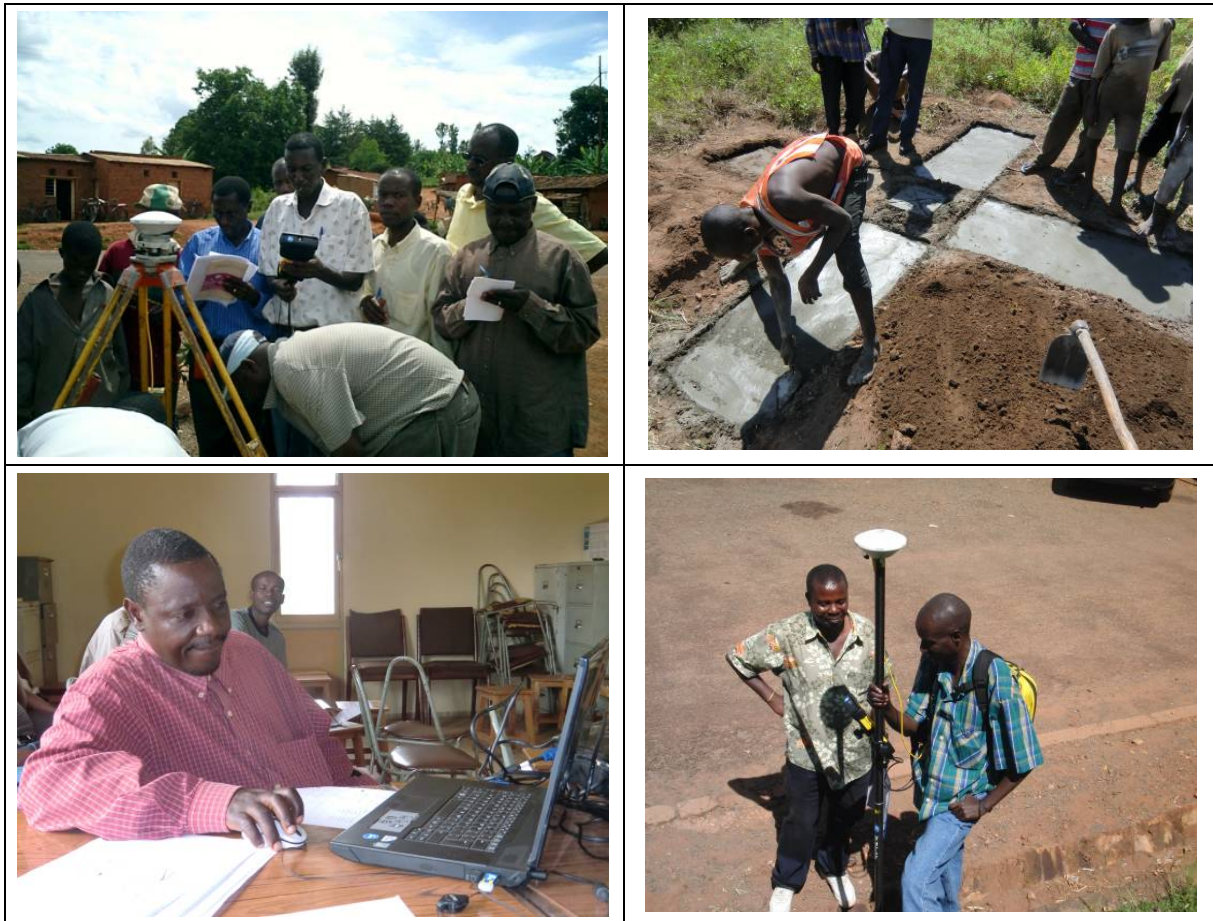
Figure 39 Scènes du transfert de technologies relatif aux levés des points de calage (en haut à gauche : observation GPS, en haut à droite : balisage d'un signe aérien, en bas à gauche : calcul d'ajustement du réseau, en bas à droite : application de l'observation GPS)
