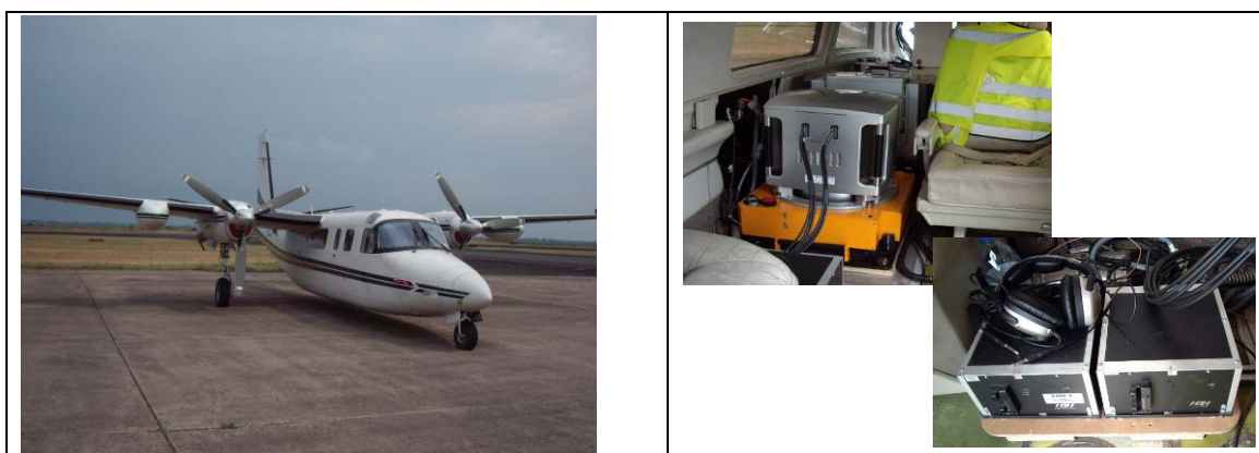
Figure. 11 Équipement des prises de vues (Gauche: aéronef utilisé; Droite: caméra numérique, équipement GPS/IMU)
