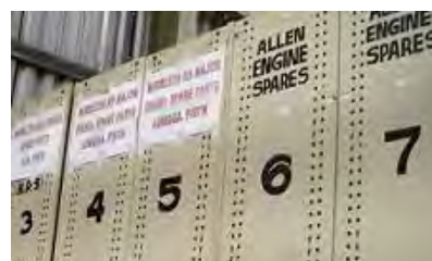
予備品・保守用工具を発電機毎に保管している棚
